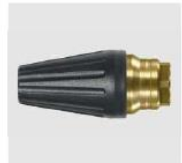
1/4" F. Spray angle 20°. 200 - 400 bar. Max. 100 °C
